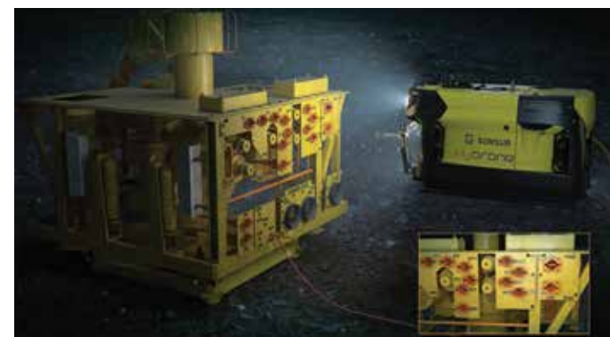
Рисунок 1. Составляющие платформы Hydronе и визуализация работы НПА Hydron-R с рабочей панелью подводного добывающего комплекса (ПДК)
