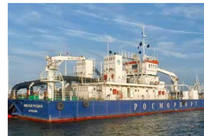
Землесос «Николай Русанов» проекта FPDG3. Оборудован системами АПС 7СУ6 и Ольм, системой ДАУ «Корвет» производства ООО ПЗ «РИАТОМ»
