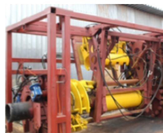
Погружной блок ремонтного комплекса
