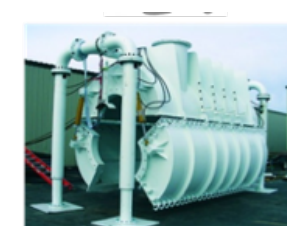
Камера для сухой подводной сварки
