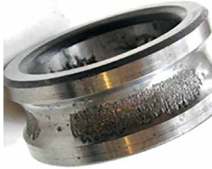
Рисунок 2 – Примеры питтинга и водородного изнашивания поверхности стальных изделий
