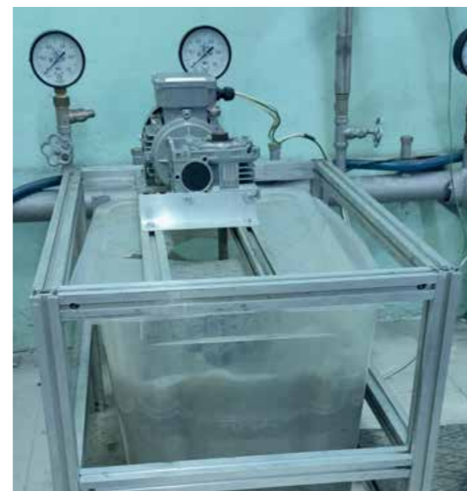
Рис. 3. Экспериментальный стенд испытаний покрытий на стойкость к гидроабразивному износу
