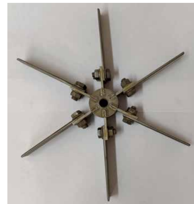
Рис. 4. Оснастка с закреплёнными образцами
