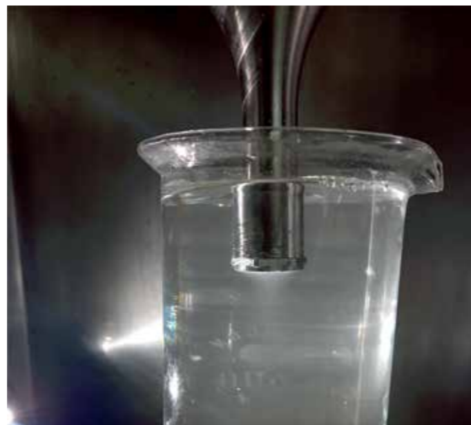
Рис. 7. Ультразвуковые возбуждения кавитации
