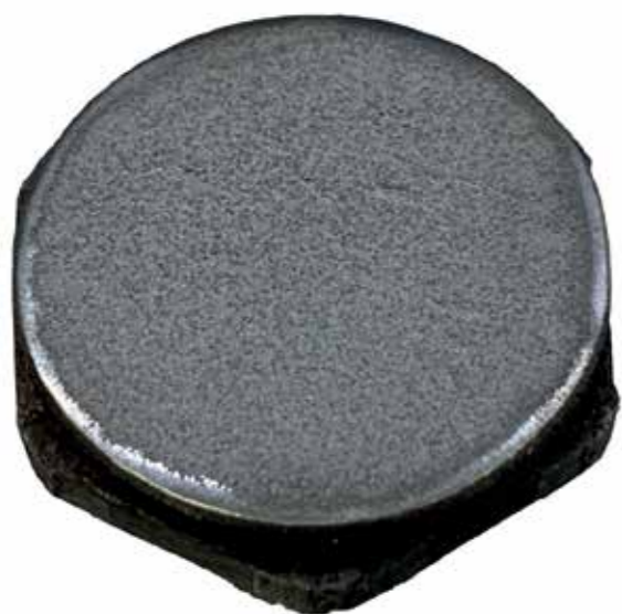
Рис. 6. Образец для испытаний напылённых покрытий на кавитационную стойкость
