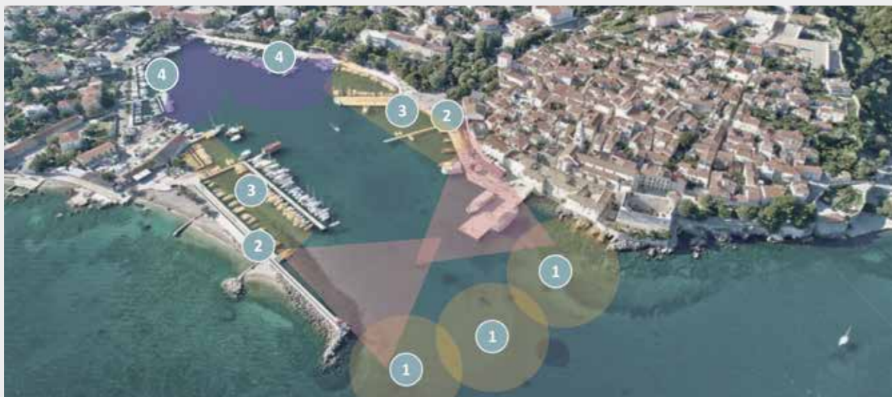
Схема 3 – информация об акустических подсистемах, предназначенных для обнаружения подводных и надводных целей, воздействия на аквалангистов
