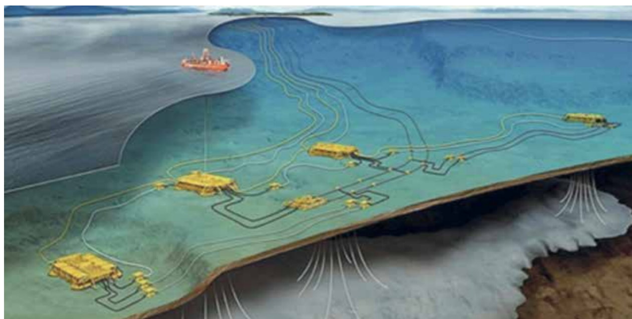
Рис. 1 Система внутрипромыслового транспорта морского месторождения
